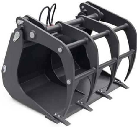
Die Entsorgungsschaufel ist das ideale Werkzeug zum Aufnehmen und Verladen von sperrigen Gütern, Bauschutt oder Gehölz. Dank der ausgesparten Seitenteile lassen sich auch große Baumstämme optimal quer aufnehmen.
