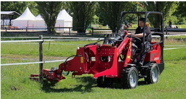
Der Zaunmäher befreit eingewachsene Zaunpfosten oder Leitplanken effektiv und schnell von Halmbewuchs. Der Mähroller wird dazu seitlich vom Lader unter den Zaun geführt. Er kann sich um die Mittelachse drehen, sobald er den Pfosten berührt und schneidet ihn somit vollständig frei. Die Kunststoffgleitschienen schützen die Pfosten vor Anfahrtsbeschädigungen.
