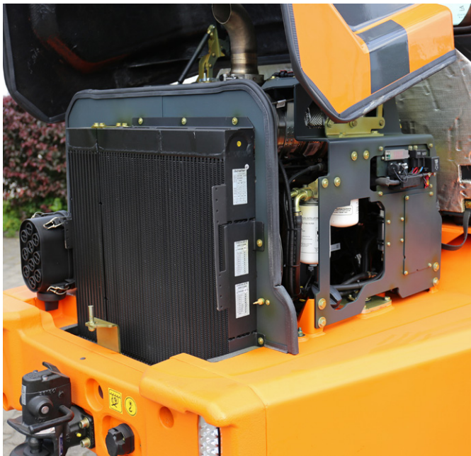
Ein 75 PS Deutz-Motor der neuesten Generation erfüllt die strenge Abgasstufe V. Alle Wartungspunkte sind gut erreichbar.
