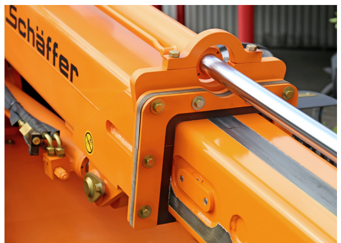
Zusätzlicher Schutz gegen das Streusalz bietet die Abdichtung des Teleskoparms.
