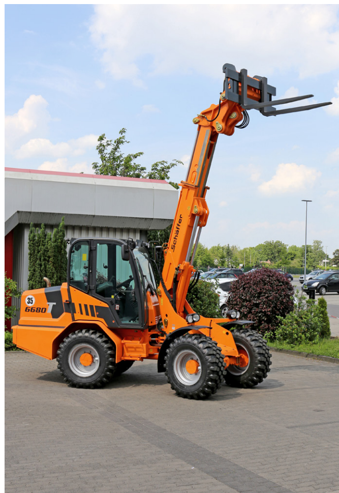
Mit einer Hubhöhe von 4,95 m am Werkzeugdrehpunkt bringt der 6680 T ideale Voraussetzungen mit zum Verladen und Stapeln von Paletten sowie zum Beladen von Streuwagen.
